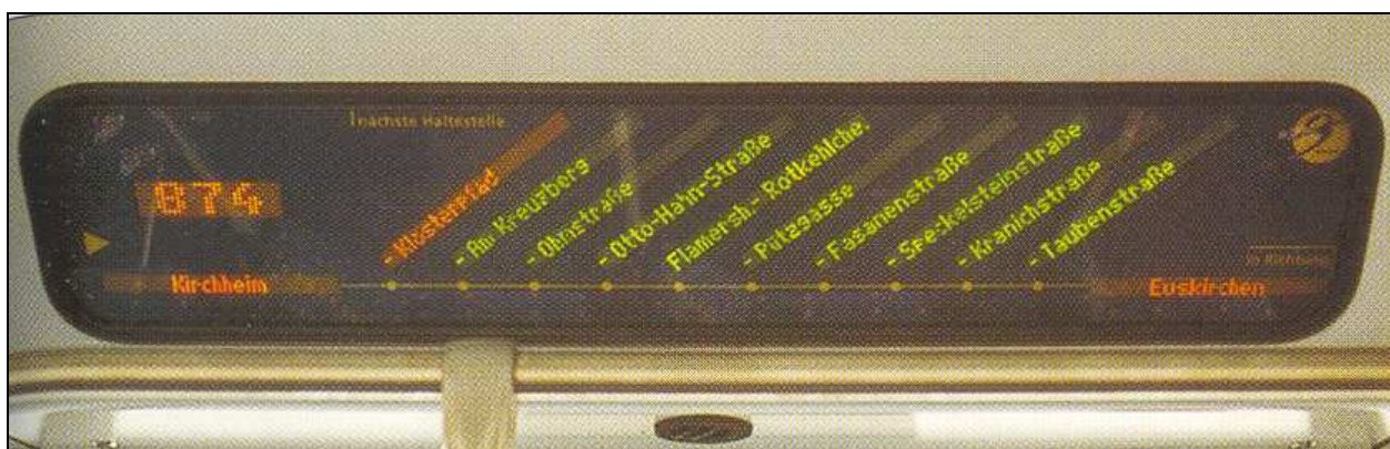
Obr. 6.3: Elektronický informační nástroj uvnitř vozidla (tzv. „teploměr“), obsahující informaci o výchozí a konečné zastávce, číslu linky a sledu následujících zastávek (MILLER-HELLMANN, 2000)
