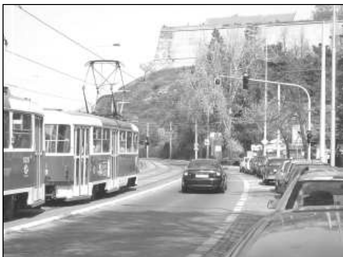
Obr. 5.1: Preference vozidel MHD na SZZ – Praha, Podolské nábřeží před vyšehradským tunelem (vozidla MHD projedou „úzkým“ tunelem bez kolize s individuální dopravou, která je na SZZ zastavena)
