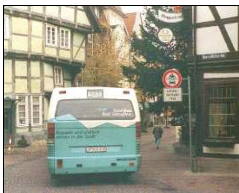
Obr. 5.4 a 5.5: Preference vyjádřená dopravním značením (povolení vjezdu vozidel MHD do míst se zákazem vjezdu motorových vozidel), resp. povolení vozidlům MHD projíždění ulic s jednosměrným provozem oběma směry (MILLER-HELLMANN, 2000)
