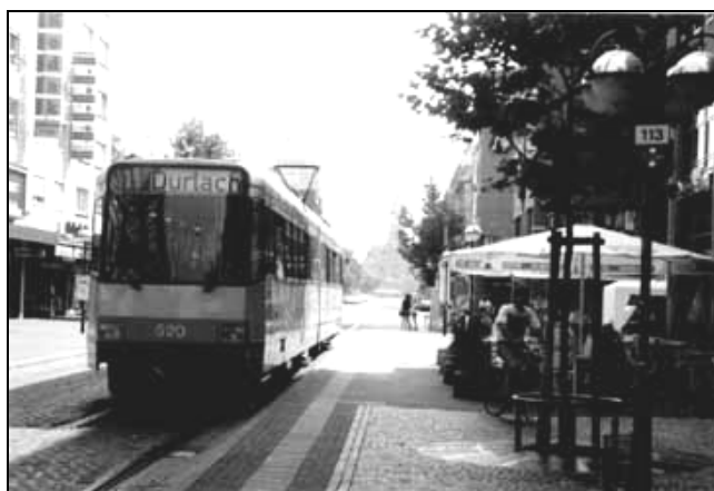
Obr. 4.2 a 4.3: Snímky z Karlsruhe – vozidla jsou v provozu jak po běžných ulicích města jako městské tramvaje, tak mohou využívat i železniční síť (www.verkehrspannung.de)
